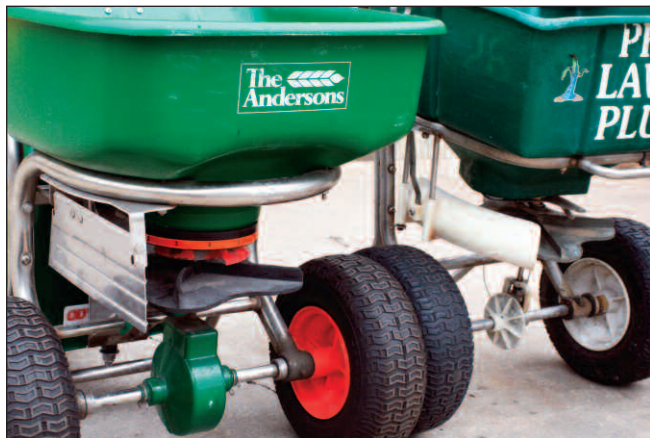
Figura 21. Dispersor con deflector.
